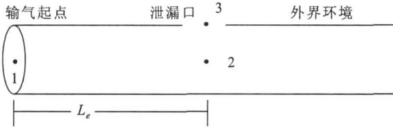
图 1 输气管道泄漏示意图
