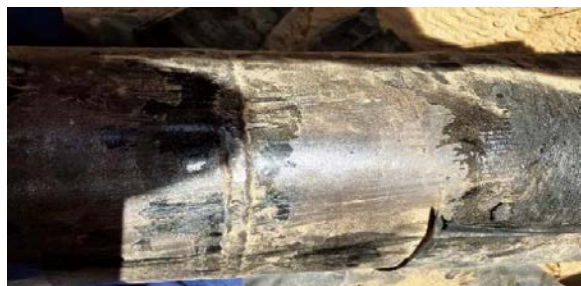
图 2 管道绝缘接头外腐蚀情况
