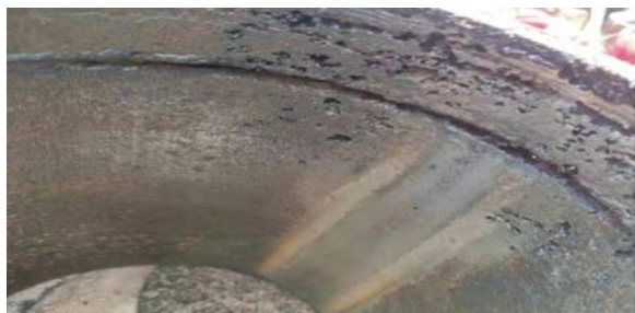
图 1 管道绝缘接头内腐蚀情况
